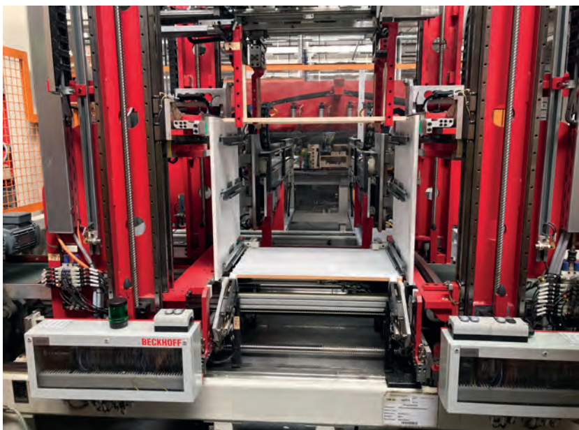
Korpusmontage mit Schubkastenführungen
