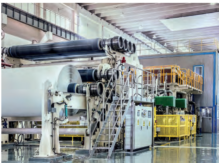
12 ft breite Dekorpapiermaschine bei Huawon
